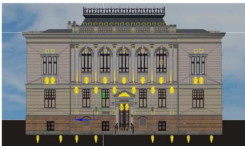
Rys.3. Rozmieszczenie oraz nacelowanie sprzętu oświetleniowego – wariant 1
