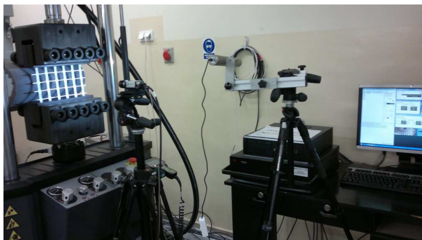
Rys. 4. Stanowisko laboratoryjne do badań geosyntetyków z wykorzystaniem metody DIC
