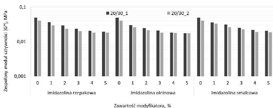
Rys. 6. Wyniki oznaczenia zespolonego modułu sztywności |G^*| w temperaturze 52°C asfaltu 20/30 modyfikowanego imidazoliną
