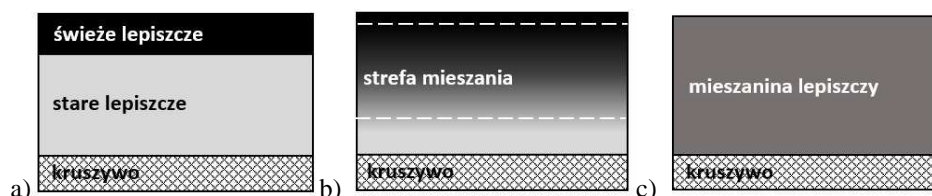
Rys. 1. Schemat mieszania lepiszczy w mieszankach z destruktem: a) brak mieszania, b) częściowe mieszanie, c) całkowite wymieszanie
