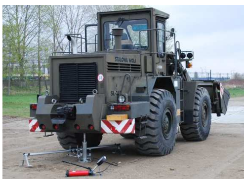
Rys. 2. Pomiar modułu odkształcenia podłoża urządzeniem VSS
