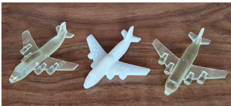
Rys. 2.18. Modele reklamowe samolotu wykonane metodą PolyJet
