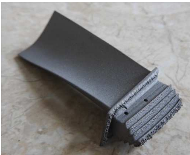
Rys. 2.8. Łopaska silnika lotniczego wykonana metodą DMLS
