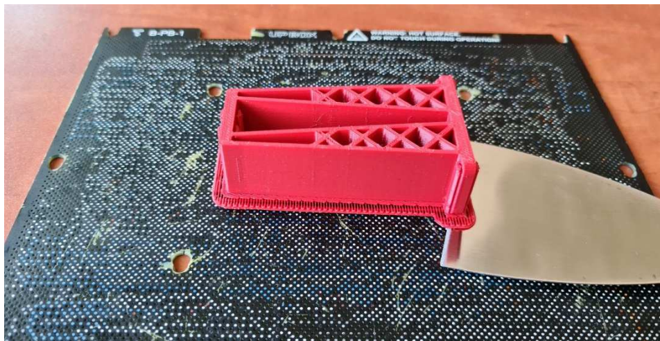
Rys. 6.17 (cd.). Postprocessing modelu wykonanego metodą MEM: b) odcięcie modelu wspomnika wraz ze strukturą podpierającą od platformy roboczej w postaci płytki perforowanej
