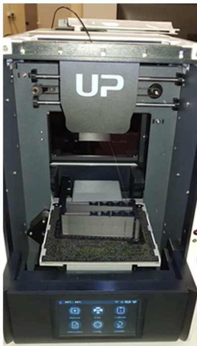
Rys. 6.15. Model badawczy w przestrzeni roboczej drukarki 3D pracującej w metodzie MEM
