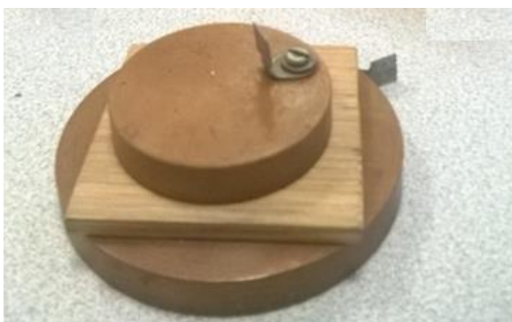
Rys. 1. Badana próbka w przestrzeni międzyelektrodowej
