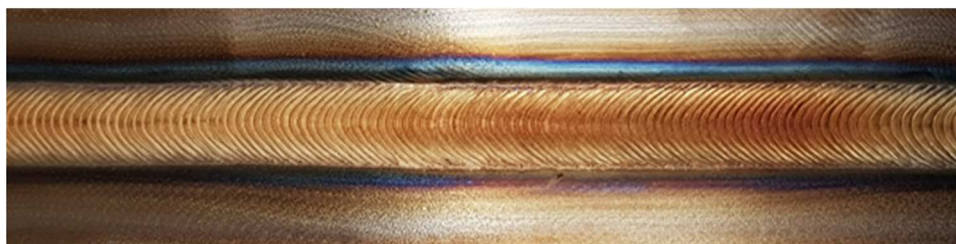
Rys. P19.3. Lico spoiny 1. wykonanej metodą PAW przed czyszczeniem, za pomocą zakupionego urządzenia Nertamatic 450
