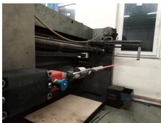
Rys. P12.4. Urządzenie ograniczające dostęp do przestrzeni roboczej z wyłącznikiem bezpieczeństwa kategorii 1.
