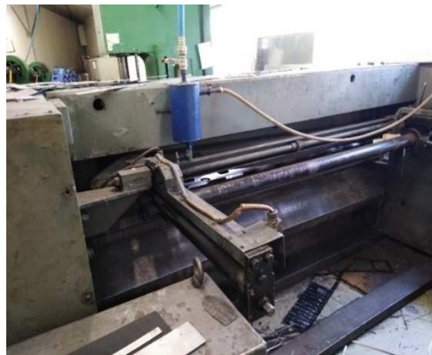
Rys. P12.2. Niezabezpieczony tył maszyny (niebezpieczny dostęp do mechanizmu tnącego)
