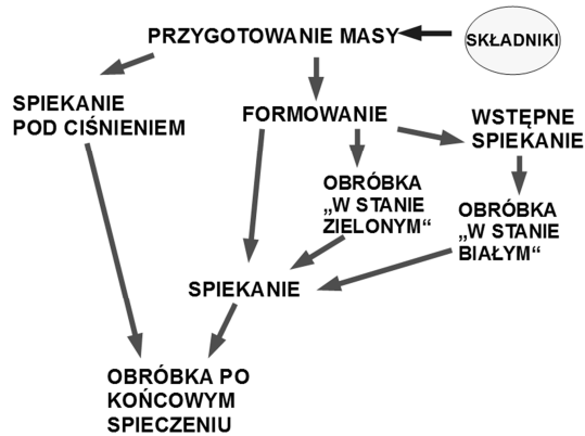
Rys. 1. Przebieg procesu technologicznego dla wyrobów ceramicznych
