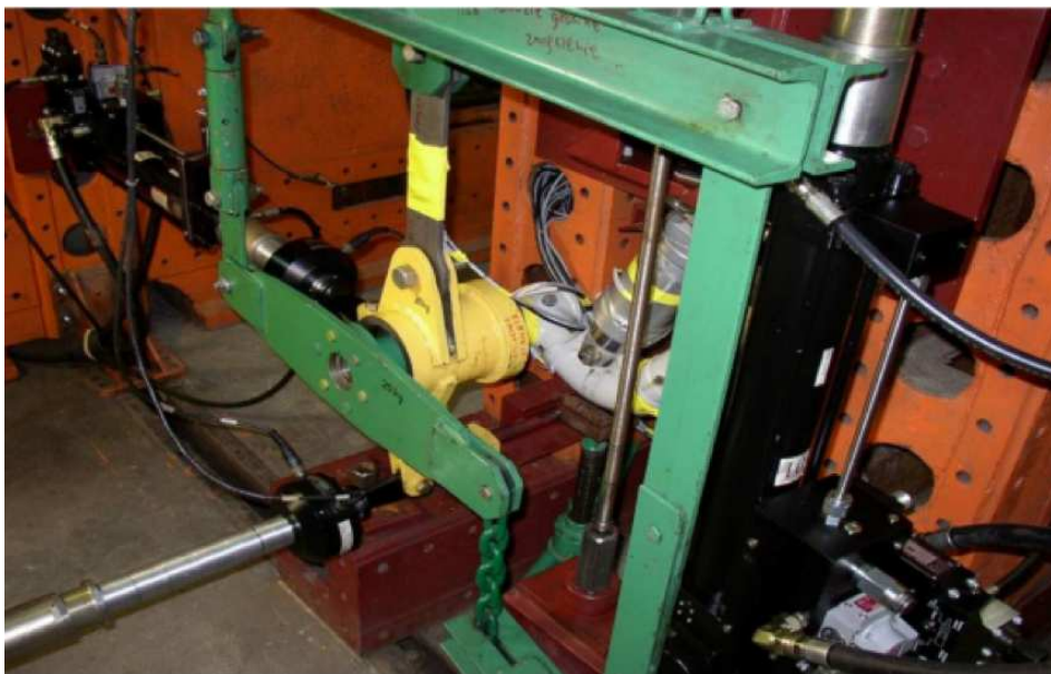
Rysunek 3.18: Stanowisko do zmęczeniowych badań pełnoskalowych podwozia głównego samolotu [12]
