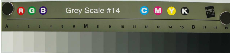
Rysunek 4.7: Znormalizowany wzorzec Danes-Picta Q14 Gray Scale do pomiaru rozpiętości tonalnej
