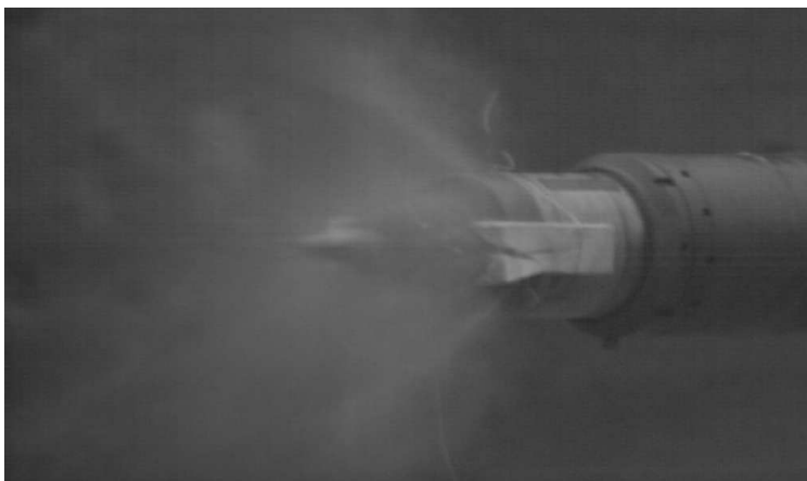
Rysunek 6.7: Pomiar czasu strzału przy użyciu krótkich wsporników
