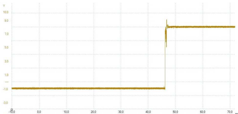
Rysunek 6.9: Krzywa pomiaru czasu strzału
