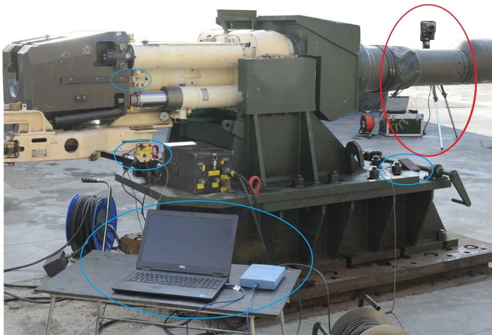
Rysunek 6.2: Układy pomiarowe do rejestracji czasu strzału za pomocą kamery szybkoklatkowej i oscyloskopu cyfrowego
