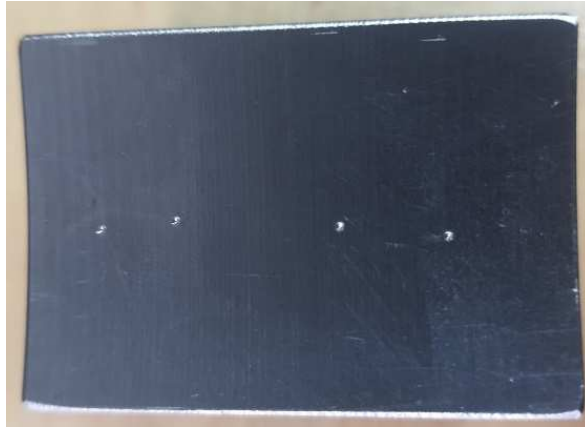
Rysunek 5.21: Stal żaroodporna J105 przed procesem nagniatania.
