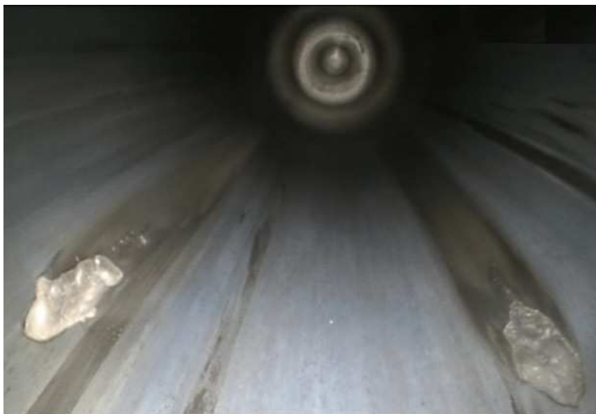
Rysunek 1.5: Występowanie wżerów i białej warstwy w przewodzie lufy 120 mm armaty
