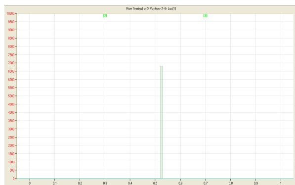
Rys. 7. Lokalizacja powstania rysy metodą AE (15.0 sec.).
