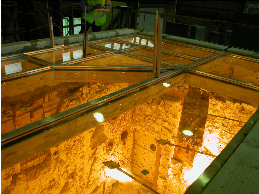
Rys. 2. Widok dachu przeszklonego od strony nienagrzewanej podczas badania
