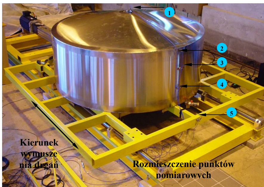
Rys. 1. Stanowisko badawcze dla modelu zbiornika o średnicy D=1,5 m
