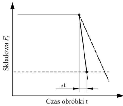
Rys. 5.8. Zmiana siły F_z spowodowana zniszczeniem wiertła, opracowano na podstawie [121]
