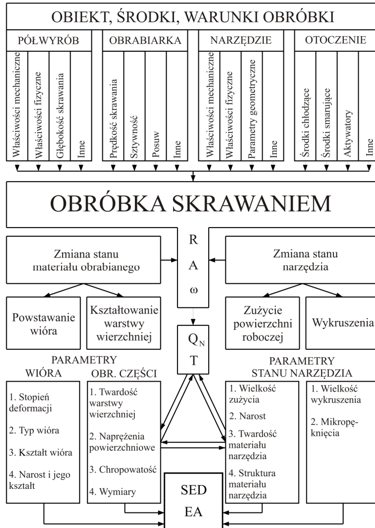
Rys. 1.3. Wzajemny związek między parametrami stanu narzędzia i parametrami procesu skrawania: A – amplituda drgań, EA – emisja akustyczna, \omega – częstotliwość kątowna drgań, R – siła skrawania, SED – siła elektrodynamiczna, Q_N – źródło ciepła, T – temperatura, opracowano na podstawie [121]
