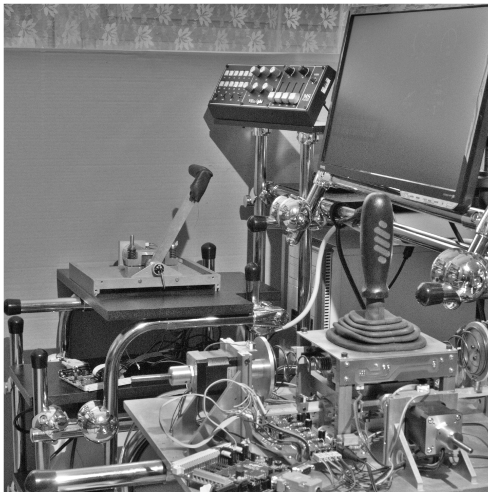
Rys. C12. Stanowisko obrazujące elementy sprzętowe – eksperymentalne urządzenia (aktywna sterownica dwuosioowa – pkt 6.2.2, aktywna dźwignia sterująca zespołem napędowym – pkt 6.2.3, pulpit sterujący i monitor aplikacji KOKPIT) (fot. P. Ciecński)
