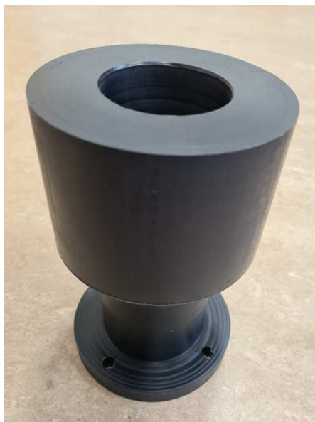
Rysunek 3.13: Widok nowego cylindra z poliamidu.
