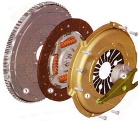
Rysunek 1.14: Sprzęgło jednotarczowe cierne suche.
