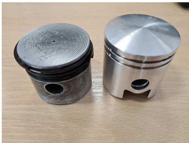
Rysunek 3.11: Oryginalny tłok sprężarki HS-11 (po lewej) oraz tłok z silnika motocyklowego (po prawej).
