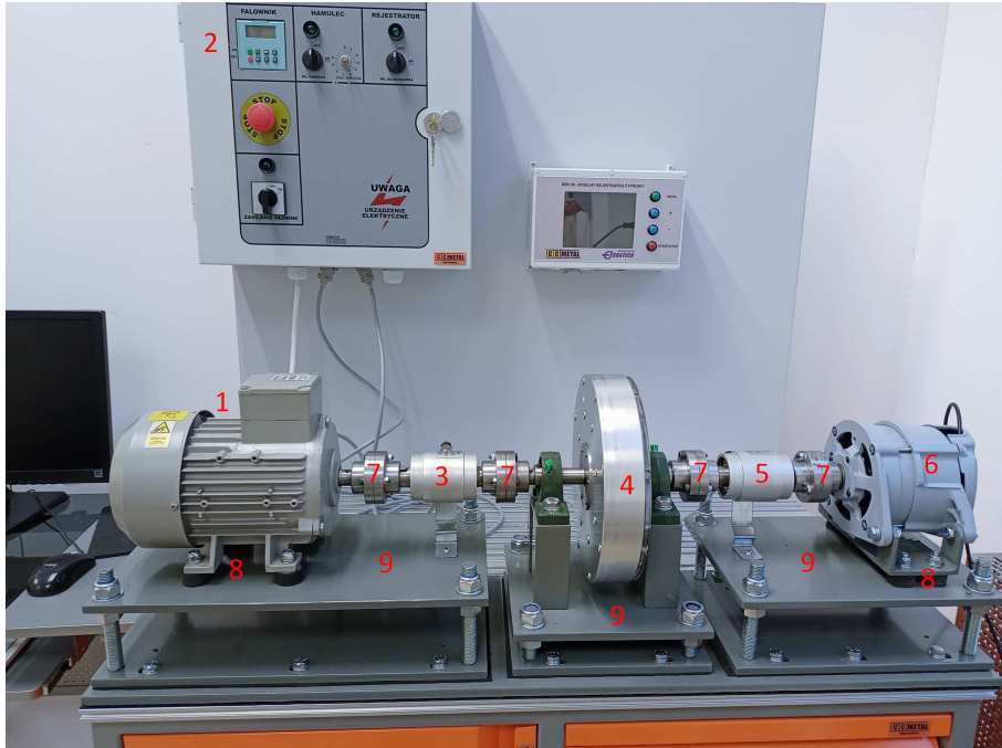
Rysunek 4.8: Zdjęcie stanowiska do badań wiskotycznych tłumików drgań skrętnych
