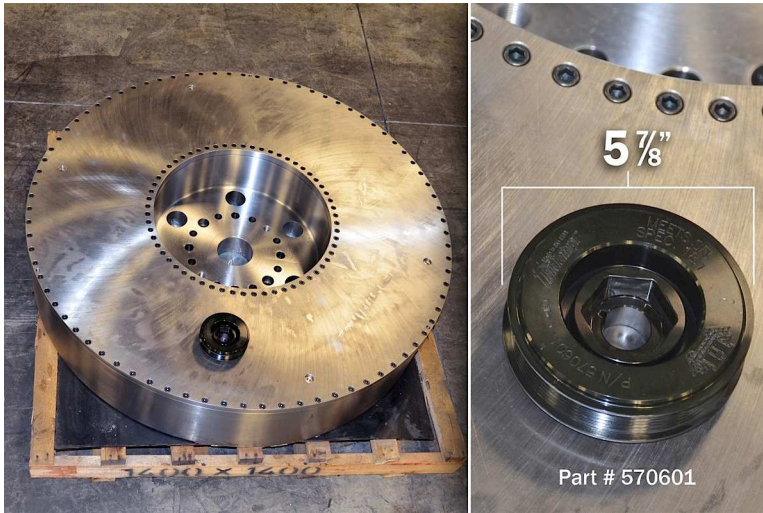
Rysunek 4.4: Przykład tłumika silnika stacjonarnego i samochodowego [16]
