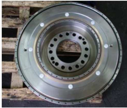
Rysunek 1.12: Wiskotyczny tłumik drgań skrętnych – widok bez pokrywy zewnętrznej.
