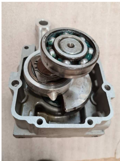
Rysunek 3.9: Układ korbowy sprężarki, z innej perspektywy. Zamontowano zabezpieczenia łożyska stopy korbowodu. Widoczny jest nadlew na korbowodzie, służący do rozbryzgiwania oleju.
