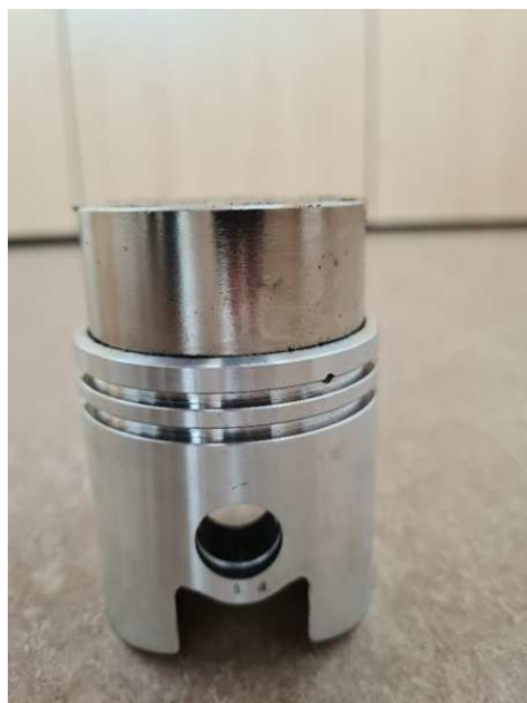
Rysunek 3.14: Widok tłoka z przymocowanym magnese neodymowym.
