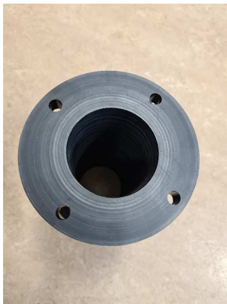
Rysunek 3.12: Widok kołnierza cylindra. Ślady widoczne w środku, to jedynie odbarwienia.
