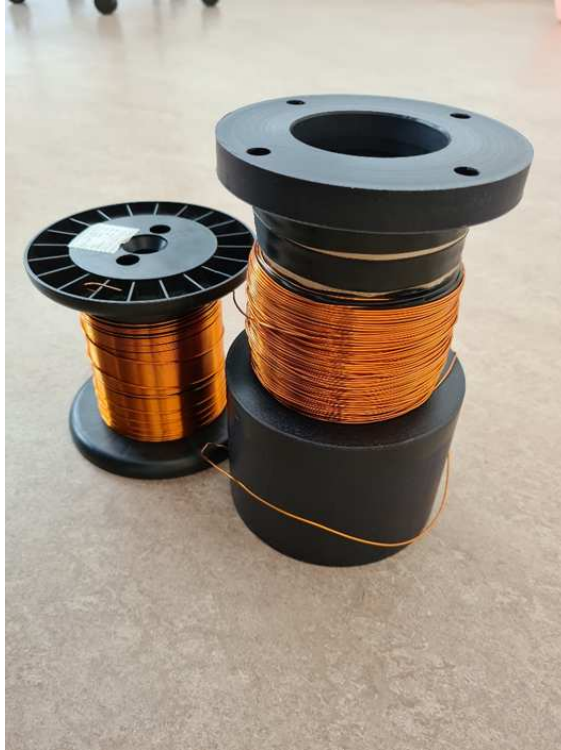
Rysunek 3.18: Cylinder w czasie nawijania uzwojenia.
