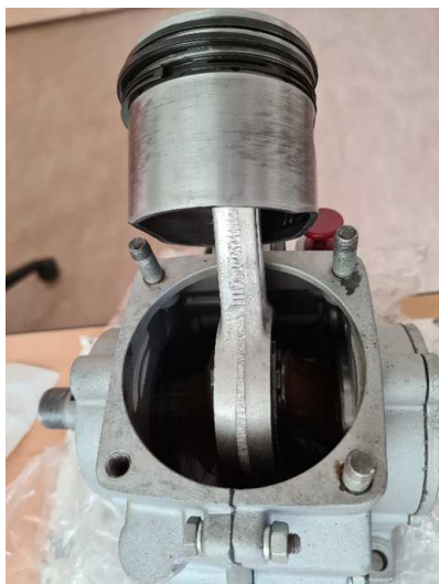
Rysunek 3.10: Sprężarka po zdemontowaniu cylindra i głowicy. Widoczny tłok z pierścieniami uszczelniającymi oraz korbowód.
