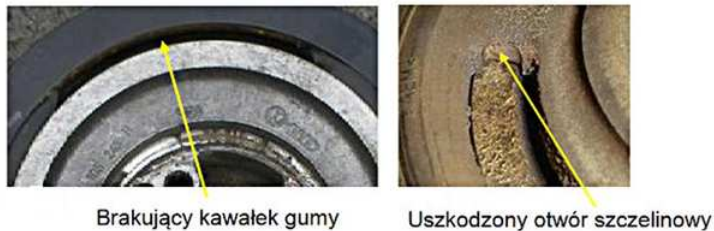
Rysunek 1.9: Brakujące fragmenty gumy.
