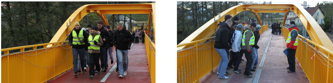
Rys. 4. Grupa osób (zespół badawczy i studenci) realizująca wybrane schematy obciążenia dynamicznego
