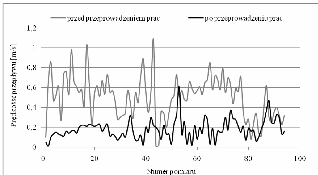
Rys. 5. Prędkość przepływu powietrza przez otwór łączącym pomieszczenie z korytarzem (opis w tekście)
