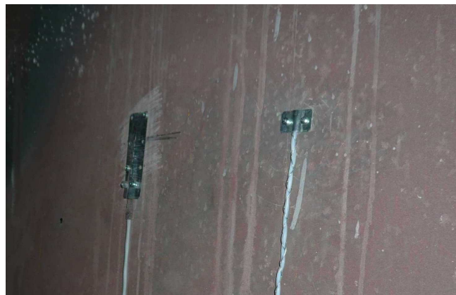
Rys. 5. Czujnik temperatury powierzchni obudowy przewodu (blacha stalowa) oraz wyprowadzenie czujnika temperatury powierzchni przewodu spalinowego w kominie o wys. 250 m
