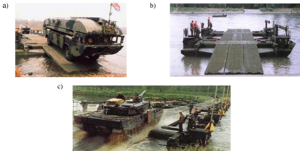
Rys. 6. Samobieżny park mostowo-promowy M3 [8]: a) amfibia M3 w położeniu transportowym; b) odcinek mostu z M3 i rampami wjazdowymi; c) przeprawa po moście z M3 pod obciążenie MLC70
