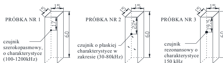
Rys. 2. Rozmieszczenie i typy czujników AE
