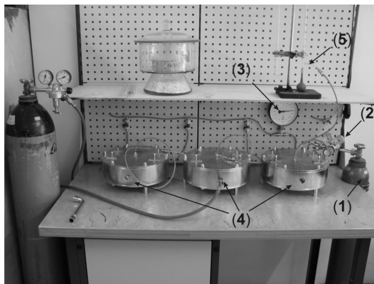
Rys.1. Stanowisko do badania przepuszczalności betonu metodą RILEM-Cembureau, 1- butla z azotem, 2- reduktor, 3-manometr precyzyjny, 4- komory do mocowania i uszczelniania próbek, 5- rurka kalibrowana do pomiaru objętości przepływającego gazu
