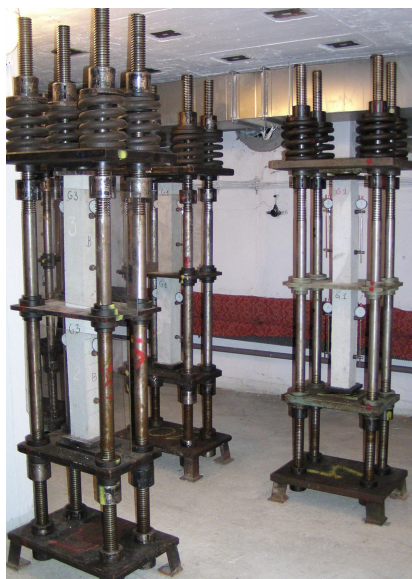
Rys. 1. Widok stanowisk do badań pełzania pod kontrolowanym stałym obciążeniem na próbkach 100 \times 100 \times 500 \text{ mm}
