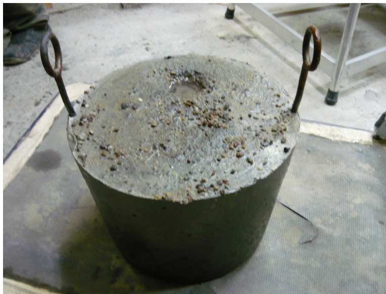
Rys. 2. Widok elementu próbnego po wyjęciu ze zbiornika i usunięciu formy PVC
