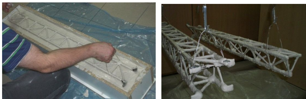
Rys. 7. Proces formowania oblodzenia na modelach kratowych
