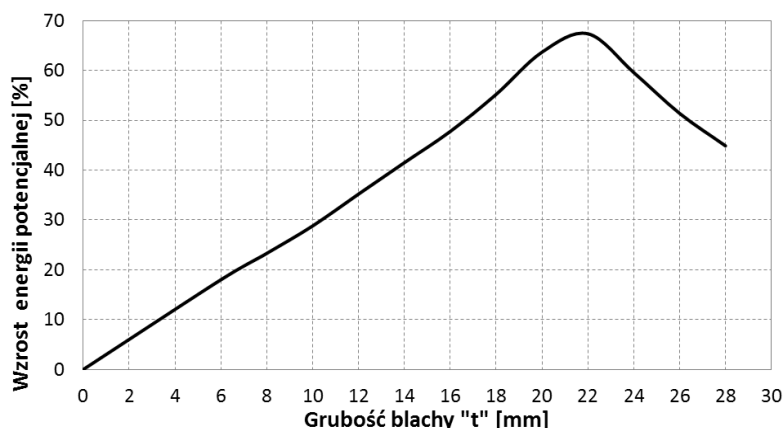
Rys. 7. Przyrost energii potencjalnej w funkcji grubości blachy wzmacniającej
