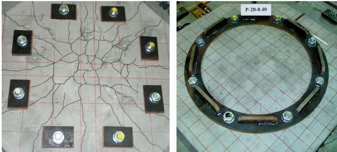
Rys. 5. Widok sposobu kotwienia płyt modeli P-15-0,32 i P-20-0,40
