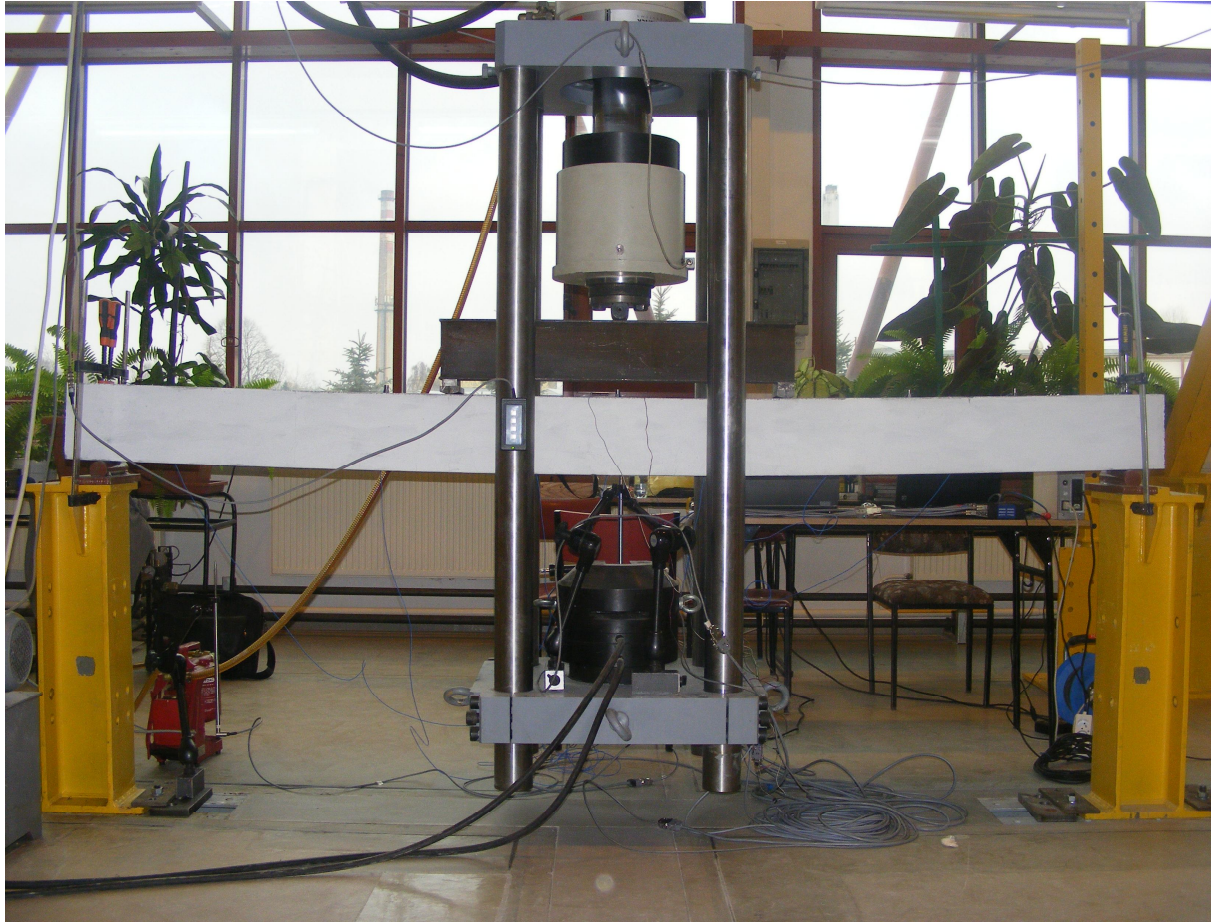
Fotografia 1. Stanowisko do badań statycznych i sposób obciążania belek
