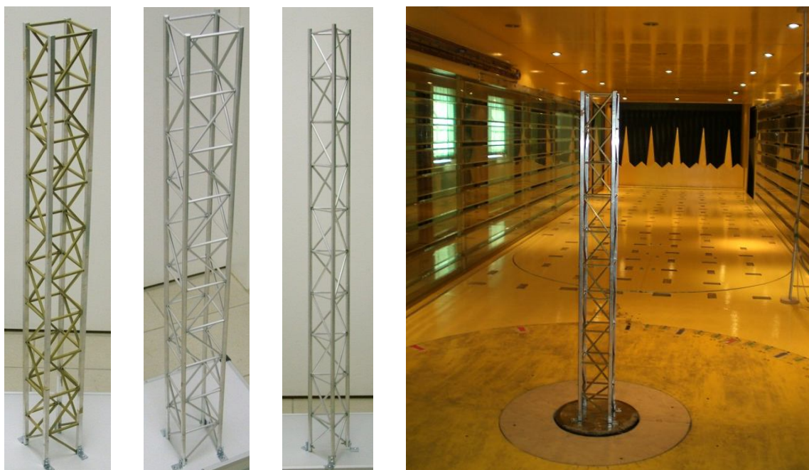
Rys. 5. Sztywne modele kratowe i ustawienie modelu w tunelu aerodynamicznym
