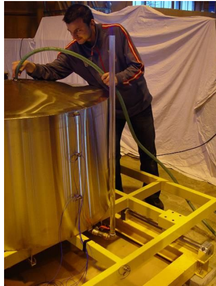
Rys. 3. Sposób wypełniania modeli zbiorników i kontrolowania poziomu słupa wody
