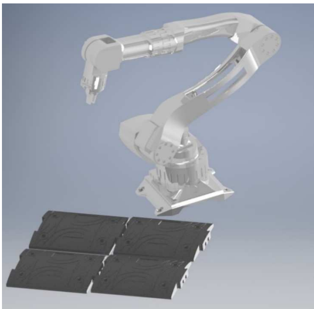
Rys. 7.18. Robot przemysłowy przegubowy przystosowany do przenoszenia progów gumowych
