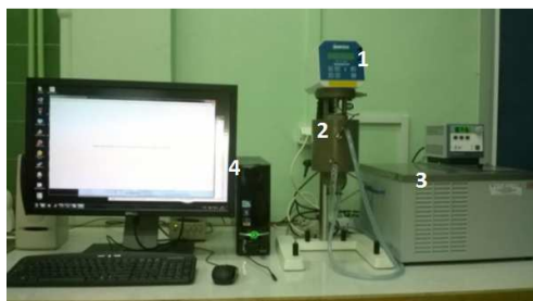
Rys. 3. Widok stanowiska pomiarowego do pomiarów lepkości: 1-reometr Brookfield'a, 2- termostatowany układ pomiarowy, 3-ultratermostat, 4-komputer sterujący reometrem
