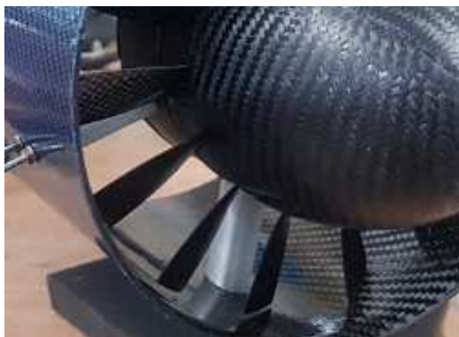
Rys. 20. Montaż z wentylatorem (test luzu wierzchołkowego)
