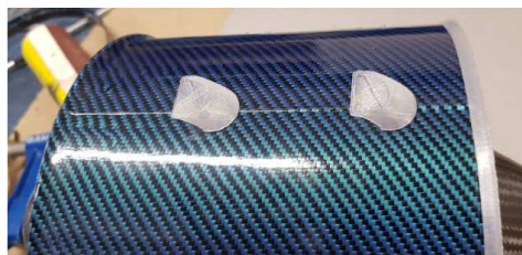
Rys. 33. Próbnny montaż wlotów na korpusie
