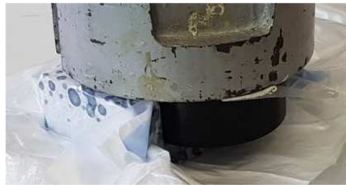
Rys. 11. Obciążenie tulei zapewniające odpowiedni docisk przelaminowanego materiału
