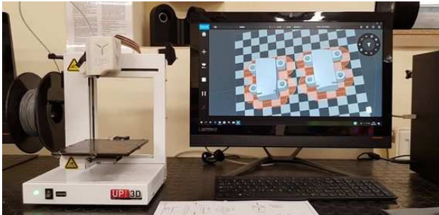
Rys. 6. Wykonanie kształtowników na drukarce 3D
