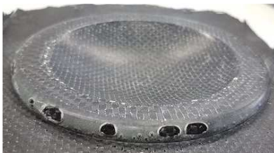
Rys. 12. Widoczne nieciągłości materiału przy zbyt słabym docisku na krawędzi tarczy
