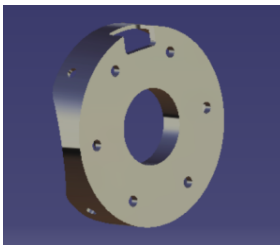
Rys. 36. Model łoża silnika (widok A)
