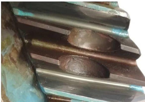
Rys. 4. Koło zębate po procesie polerowania elektrolitycznego – efekt końcowy
