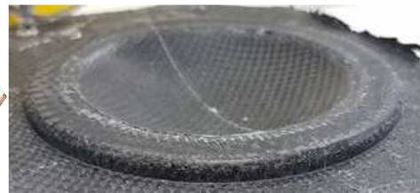
Rys. 13. Poprawnie wykonana tarcza
