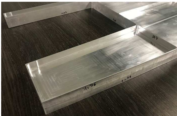
Rys. 9. Gotowa belka wzdłużna wykonana metodą HSM dla współczynnika wysokości ścianek do grubości < 15:1
