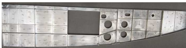
Rys. 6. Belka samolotu (struktura cienkościenna) wykonana w technologii frezowania HSM
