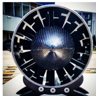
Rys. 40. Złożony, z zastosowaniem modelu silnika, zespół chłodzący (widok B)
