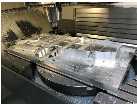
Rys. 6. Belka samolotu (struktura cienkościenna) wykonana w technologii frezowania HSM
