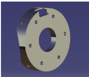
Rys. 36. Model łoża silnika (widok A)
