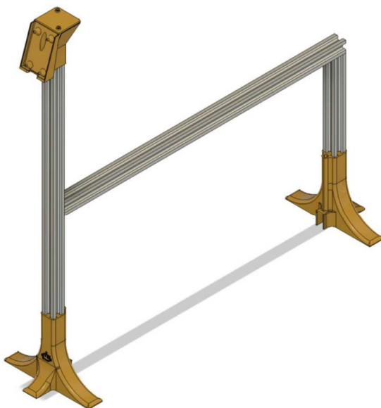
Rysunek 1. Projekt wykonany w technologii druku 3D bramki pomiarowej Źródło: opracowanie własne.
