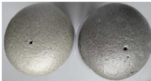
Fot. 3. Pianki poddane badaniu współczynnika przewodzenia ciepła. Od lewej: Mel+GE 096, GE 096 (30%).
