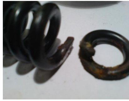
Rys. 23. Pęknięta sprężyna zaworu pilotującego
