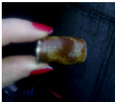
Rys. 19. Zanieczyszczony filtr instalacji sterującej
