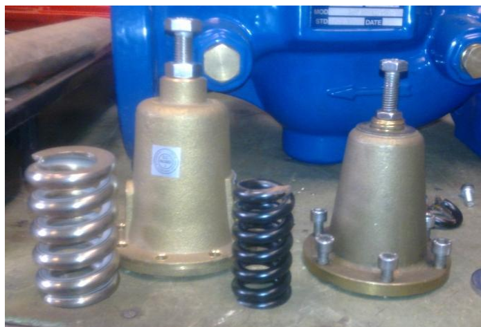
Rys. 10. Porównanie wielkości zaworów pilotowych oraz odpowiadających im sprężyn
