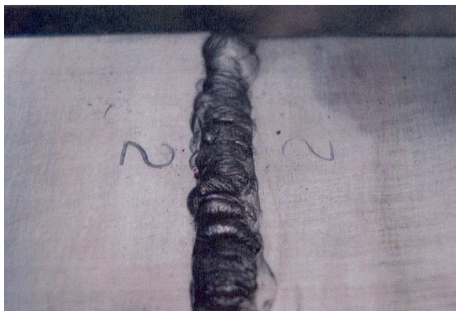
Rys. 3. Przykład nieprawidłowo wykonanej spoiny spawalniczej ze względu na zbyt małą ilość gazu osłonowego z drugiej strony łączonych elementów
