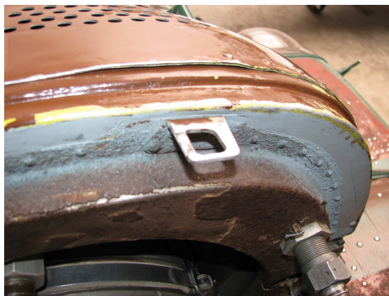
Rys. 6. Przegroda ochronna śmigłowca W-3 pokryta szpachlówką ognioodporną
