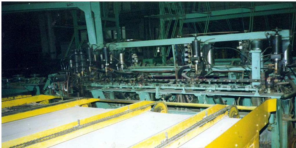
Рис. 2. Технологический комплекс по изготовлению пространственных каркасов из проволоки диаметром 3 ... 6 мм
