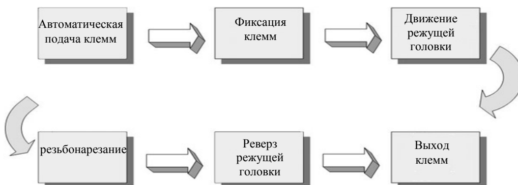
Рис. 2. Схема движения производства клемм Rys. 2. Schemat struktury procesu wytwarzania styków
