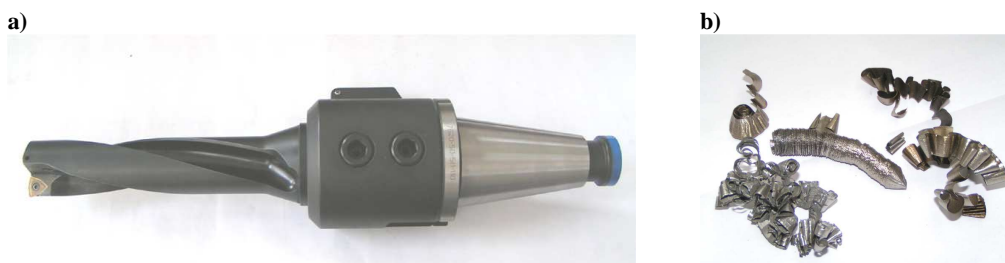
Rys. 3. Wiercenie otworu wstępnego: a) narzędzie, b) wióry
