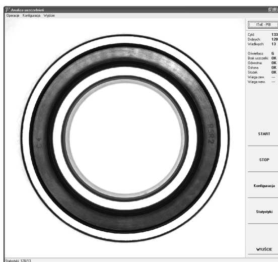
Rys. 8. Wygląd okna pomiarowego aplikacji dla systemu MS Windows przeznaczonej do detekcji wad uszczelnień łożysk tocznych
